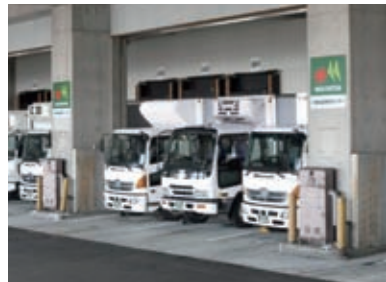
納入口にビタリと横付けされ、外気に触れることなく荷下ろしや積荷がされています。
