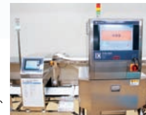
金属探知機とX線異物検査機。
