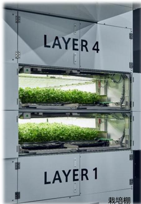
THE TERRABASE で、レタスは、完全密封、完全機械化された環境で育ちます。レタスを栽培する装置は、複数の栽培棚が個別に密閉されています。栽培棚は AI 等を活用して探索した最先端の栽培条件に基づいて、レタスの成育に最適な光の量、空気、栄養素を制御していますが、この密閉方式を採用することにより、従来以上に精密な環境制御が可能となりました。これらのプランテックスの技術が、サステナブルで安全・安心、栄養価が高い未来志向のレタスを育みます。
